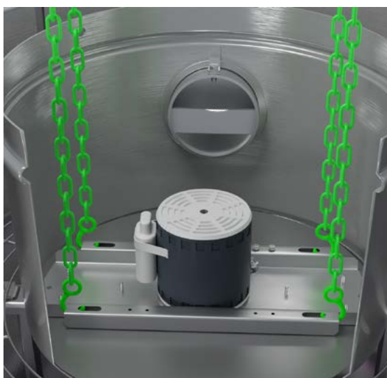
Modèle VCU (Plaque de support de moteur dotée de quatre points de levage)
